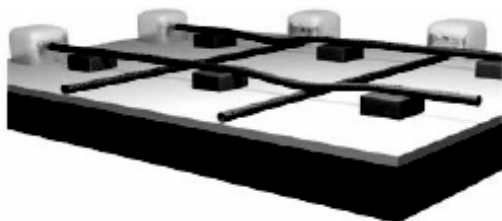
Gambar 9 Gambaran tiga-dimensi suspended nanotube device architecture yang menunjukkan empat junction pada perangkat memori. Dua elemen pada keadaan ON (saling bersentuhan) dan dua elemen lagi pada keadaan OFF (terpisah) [13].
